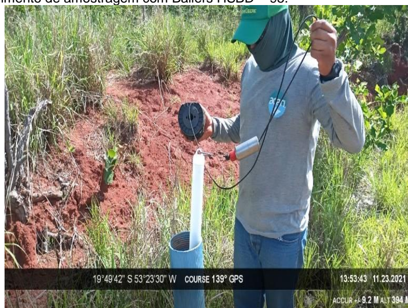
Figura 4 - Procedimento de amostragem com Bailers HSBD – 95.
