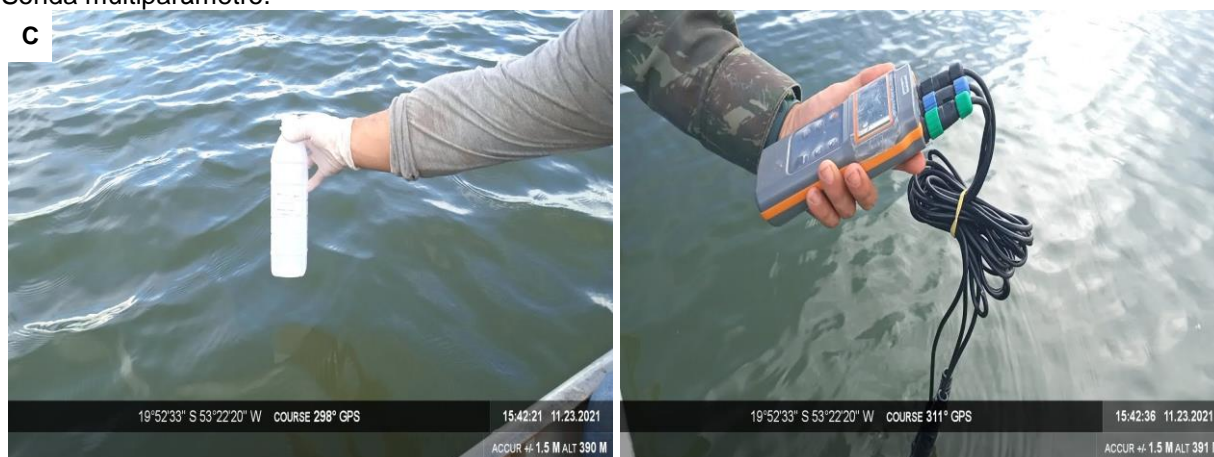
Figura 3 - Procedimentos de amostragem. A: Frasco de polietileno para análises físico-químicas; B: Sonda multiparâmetro.
