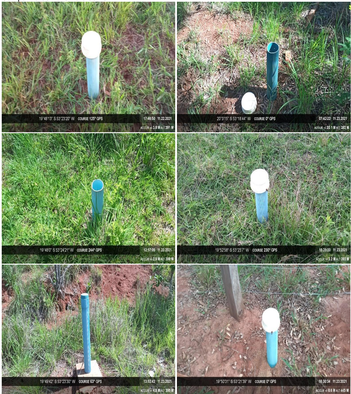
Figura 1 - Poços de monitoramento da PCH Verde 4A. Pontos de cima para baixo: P1 a P6. Campanha de novembro de 2021.
